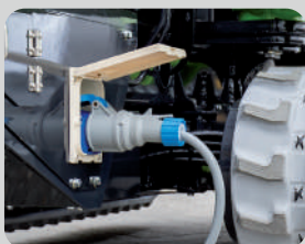
Laden Sie das UM445 während der Arbeit mit einer 110/240-V-Stromversorgung auf
