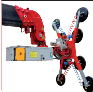
Système ventouses robotisé
