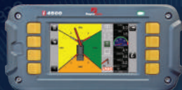
Contrôleur d'état de charge (CEC) du calage asymétrique en option
