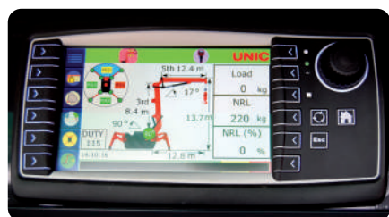
Contrôleur Electronique de Charge (CEC) à écran haute résolution, en couleur
