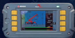
Contrôleur Electronique de Charge (CEC) en standard
