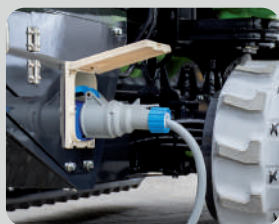
Caricamento della gru UM445 con alimentazione da 110/240 V durante il funzionamento
